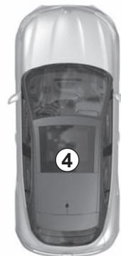
**Com o motor desligado** e se, depois de ter aberto e fechado uma porta, o cartão já não estiver na zona 4, a mensagem «Cartão não-detetado» alerta o condutor de que o cartão já não se encontra no veículo. Isto permite evitar, por exemplo, que o veículo se desloque depois de um passageiro sair com o cartão.
