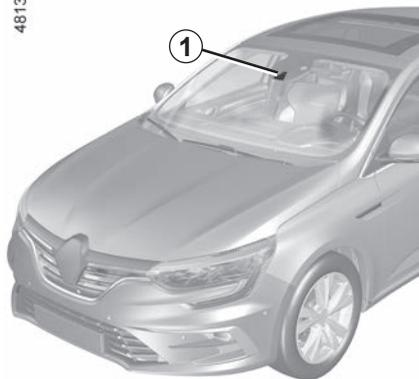
O sistema deteta os sinais de limite de velocidade à beira da estrada e apresenta o limite de velocidade no quadro de instrumentos.
