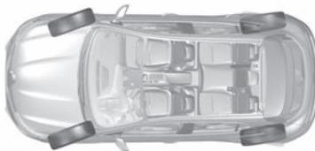
Ao circular a velocidades mais elevadas, as rodas traseiras orientam-se no mesmo sentido das rodas dianteiras (figura **B**), para otimizar a estabilidade do veículo. Isto é muito útil ao mudar de via, ao curvar, etc.
