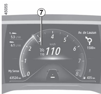
O testemunho **7** desaparece do quadro de instrumentos para confirmar que a função não está ativa.
