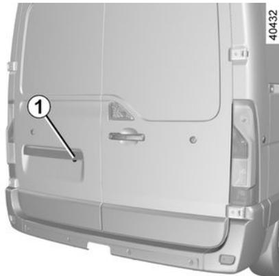
Ao engrenar a marcha-atrás, a câmara **1** situada sobre o portão traseiro ou, consoante o veículo, sobre a porta batente traseira, transmite uma visão da zona atrás do veículo no retrovisor **2** ou, consoante o veículo, no visor multimédia **3**, acompanhada por uma ou duas guias **4** e **5** (móvel e fixa).
