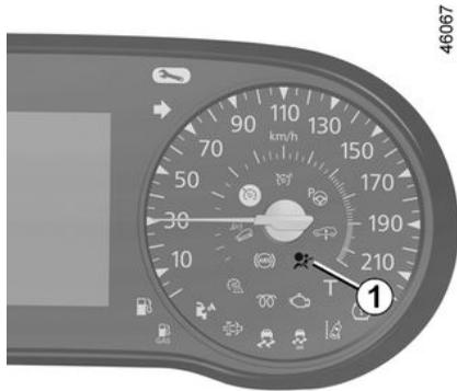
O testemunho 1
