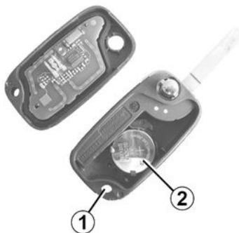
Abra a caixa pela ranhura **1** com uma chave de fendas ou uma ferramenta semelhante e substitua a pilha **2**, respeitando o tipo e a polaridade gravados no fundo da tampa.
