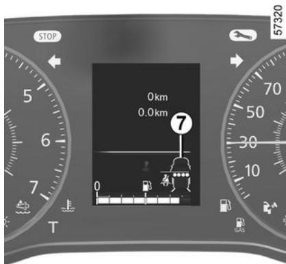
O testemunho **7** é apresentado no quadro de instrumentos quando a ignição é ligada. Isto informa sempre o condutor se o cinto de segurança dos lugares traseiros está ou não encaixado:
