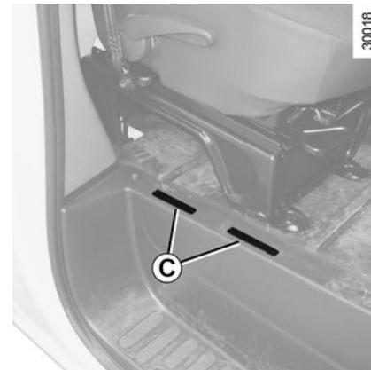
Para aceder ao tipo de chassis do veículo e número na série do tipo, desencaixe, com uma chave de fendas ou ferramenta semelhante, as tampas C.
