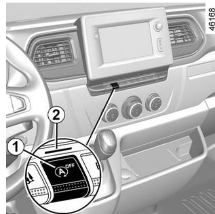
Prima o interruptor **1** para desativar a função. O testemunho **2** acende-se.
