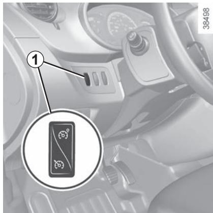
O limitador de velocidade é uma função que lhe permite decidir a que velocidade máxima, designada por **velocidade limitada**, pretende circular.
