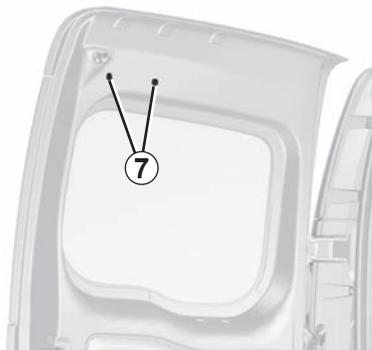
Pelo interior, extraia os dois obturadores plásticos 7. Desencaixe a luz, com uma chave de fendas; para isso, pressione o alojamento das molas metálicas.
