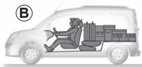
Coloque sempre os objectos mais pesados directamente sobre o piso do compartimento de carga.
