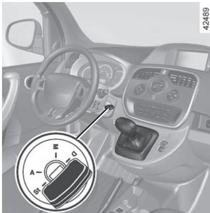
Antes de proceder ao reboque, insira a chave no interruptor da ignição para destravar a coluna de direcção. Rode a chave para a posição **M**.
