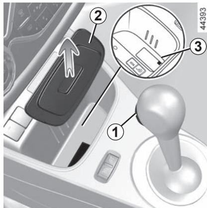
Se a alavanca ficar bloqueada em **P**, ainda que o pedal do travão seja pressionado e o botão de desbloqueio **1** seja premido, continuará a ser possível libertar manualmente a alavanca. Para tal, remova o tapete **2** na parte inferior do porta-objetos para aceder à alavanca de desbloqueio **3**. Em seguida, levante a alavanca **3** e prima simultaneamente o botão de desbloqueio **1** na alavanca.
