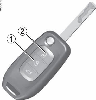
Se o veículo estiver equipado com supertrancamento, este sistema permite trancar os abríveis e tornar impossível a abertura das portas através dos manípulos interiores (no caso, por exemplo, de um vidro partido seguido de tentativa de abertura da porta pelo interior).
