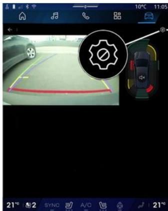
Quando a marcha-atrás é engrenada, a câmara de marcha-atrás situada na traseira do veículo é ativada para transmitir a vista da retaguarda do veículo para o ecrã multimédia.
