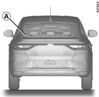
O Código QR na etiqueta A permite que os técnicos de emergências utilizem um tablet ou smartphone para aceder imediatamente às informações técnicas úteis para intervir no veículo em caso de acidente
