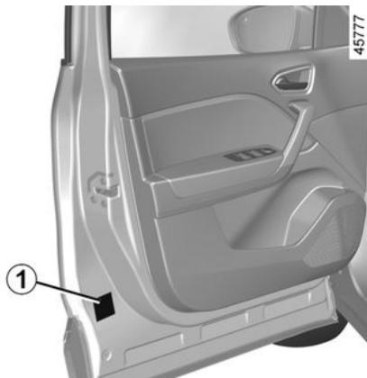
O sistema estará montado se existir uma etiqueta **1** no veículo.
