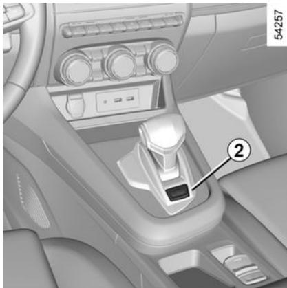
Com o veículo imobilizado, o motor a trabalhar ou a ignição ligada (com a mensagem READY no quadro de instrumentos da versão E-Tech full hybrid), prima o botão **2** para engrenar a posição P. O testemunho no botão **2** acende-se a laranja assim que a posição de Estacionamento P da caixa de velocidades é engrenada.
