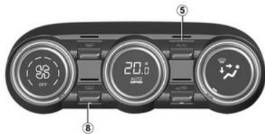
Prima o botão **8**: o testemunho integrado acende-se. Esta função permite um desembaciamento rápido ou o degelo do óculo traseiro e dos retrovisores (em veículos equipados).
