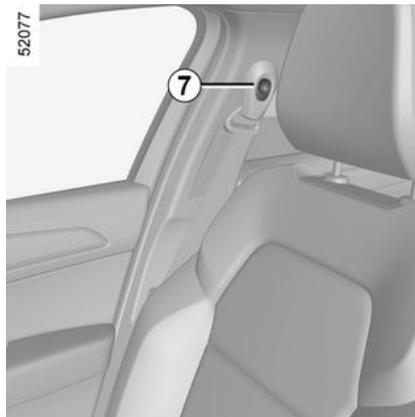
Utilize o botão **7** para regular a altura do cinto de segurança, de modo a que o segmento torácico fique conforme indicado anteriormente. Prima o botão **7** e suba ou desça o cinto. Depois de concluída a regulação, assegure-se do seu correto travamento.
