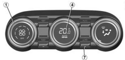
Esta função é gerida automaticamente (o funcionamento é confirmado pelo acendimento de um testemunho no botão **7**), mas também pode ser ativada manualmente.
