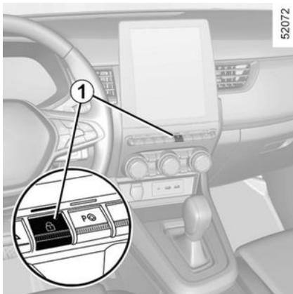
Depois de o veículo ser ligado, o sistema trancará automaticamente as portas quando o veículo circular a aproximadamente 10 km/h e a velocidades superiores.
