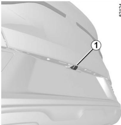
Quando o veículo está em marcha-atrás, a câmara **1** situada na tampa do porta-bagagens transmite uma visão da área circundante atrás do veículo no visor multimédia **2**, acompanhada de duas guias **3** e **4** (móvel e fixa).
