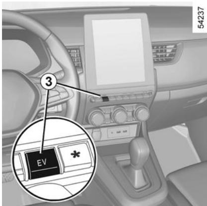
Quando o sistema híbrido utiliza o motor de combustão com ou sem o motor elétrico para propulsionar o movimento do veículo, é possível passar para o modo exclusivamente elétrico.
