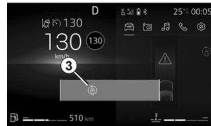
Se o veículo tiver parado como resultado da travagem de emergência ativa, o condutor deverá manter o veículo imobilizado carregando no pedal do travão.
