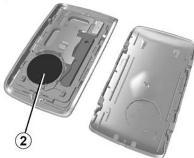
Quando a mensagem "Pilha do cartão fraca" for apresentada no quadro de instrumentos, substitua a pilha do cartão:
