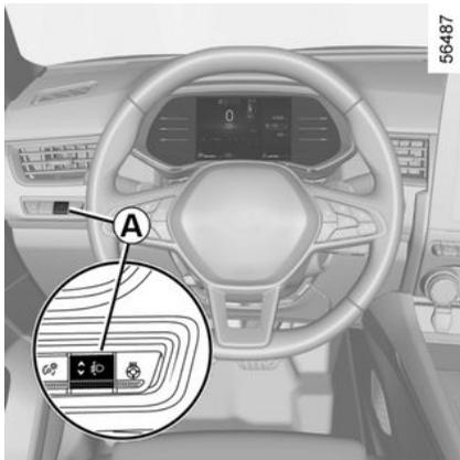
O interruptor **A** é utilizado para regular a altura do feixe dos faróis em função da carga.
