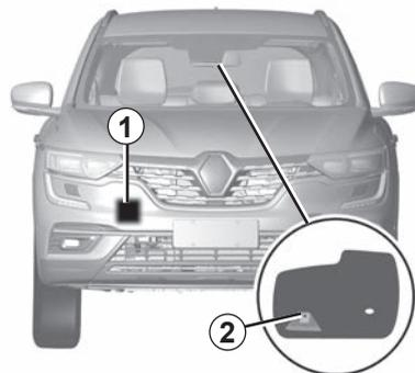
O sistema **A** é constituído pelo sensor de radar **1** e pela câmara dianteira **2**.
