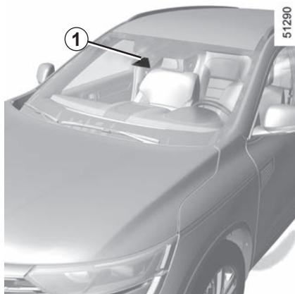
O alerta de excesso de velocidade com reconhecimento de painéis de sinalização, informa o condutor se este ultrapassar o limite de velocidade imposto para o troço de via no qual se encontra.
