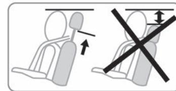
**Nota:** Quando for necessário montar novamente o apoio de cabeça, preste atenção à respetiva posição, a qual está desenhada na etiqueta.
