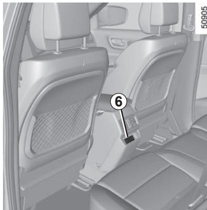
As tomadas USB permitem igualmente recarregar acessórios homologados pelos Serviços técnicos da marca, cuja potência não exceda 10,5 Watts (tensão: 5 V) por tomada.
