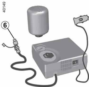
Logo que o pneu esteja à pressão preconizada, retire o kit: desaperte lentamente a ponteira de enchimento **6** de modo a evitar a projecção de produto e guarde a garrafa numa embalagem plástica para evitar que o produto escorra.
