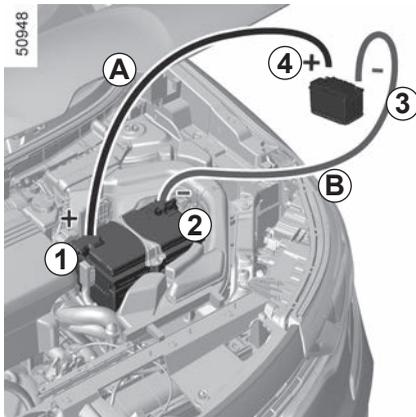
Levante a capa e, depois, a tampa vermelha do borne **1** (+).
