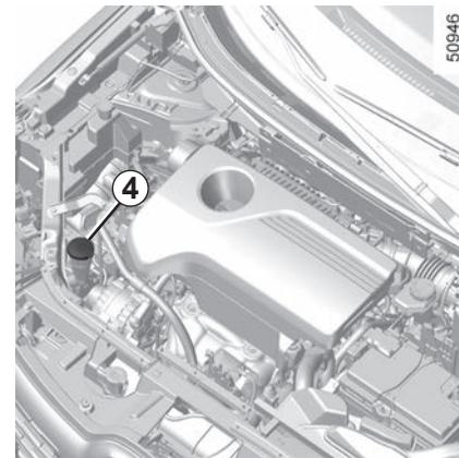
Lado direito do veículo, é necessário desmontar o bocal de enchimento **4** do depósito do lava-vidros para aceder às lâmpadas. Para isso:
