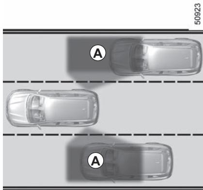
Este sistema informa o condutor quando outro veículo se encontra no perímetro de detecção **A**.
