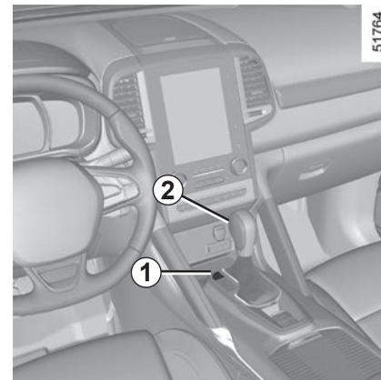
Ao pôr o motor a trabalhar, se a alavanca ficar bloqueada na posição **P** com o pé no pedal de travão, é possível desbloqueá-la manualmente. Para tal, desencaixe a tampa **1** e, em seguida, insira uma ferramenta (com uma haste rígida) no orifício e prima simultaneamente o botão **2** para desbloquear a alavanca.
