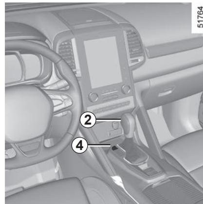
**Ao pôr o motor a trabalhar**, se a alavanca ficar bloqueada na posição **P** com o pé no pedal de travão, é possível desbloqueá-la manualmente. Para tal, desencaixe a tampa **4** e, em seguida, insira uma ferramenta (com uma haste rígida) no orifício e prima simultaneamente o botão **2** para desbloquear a alavanca.
