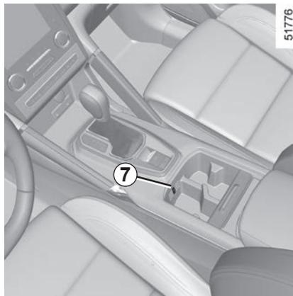
Levante o botão 7 para ventilar o compartimento de arrumação de acordo com a temperatura definida pelo ar condicionado. Baixe o botão para parar a função.
