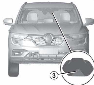
O sistema **B** utiliza o sensor da câmara de radar **3**.
