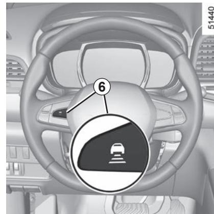
A velocidade de regulação substitui os traços e a função de regulação é confirmada pela apresentação da mensagem «adaptat Regulador» e pelo teste-luz .
