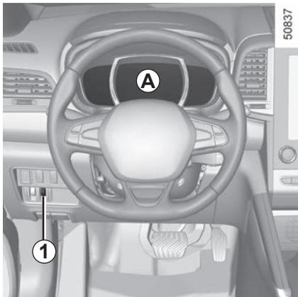
**Quadro de instrumentos A:** acende-se quando a porta do condutor é aberta. Com a ignição ligada, gire a roda **1** para regular a luminosidade do quadro de instrumentos.
