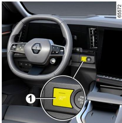
Prima o interruptor **1** para desativar a função. A mensagem "Stop & Start desativado" é apresentada no quadro de instrumentos e o testemunho do interruptor **1** acende-se.
