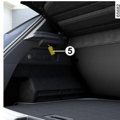
Desencaixe (com o auxílio de uma chave de fendas ou semelhante) a luz da bagageira **5** premindo a lingueta no respetivo lado esquerdo.
