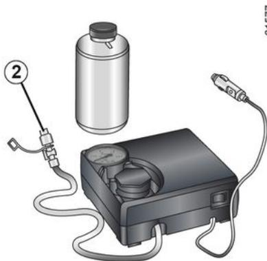
Quando o pneu estiver devidamente cheio, remova o kit: desaperte lentamente o adaptador de enchimento do recipiente **2**, de modo a evitar a projeção de produto e, em seguida, guarde o recipiente numa embalagem de plástico para evitar fugas de produto.
