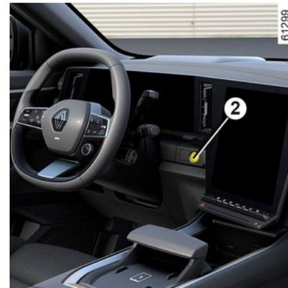
Se o smartphone deixar de estar no habitáculo quando a paragem do motor for solicitada, será apresentada uma mensagem no quadro de instrumentos: pressione e segure o botão start/stop do motor **2** durante mais de dois segundos.
