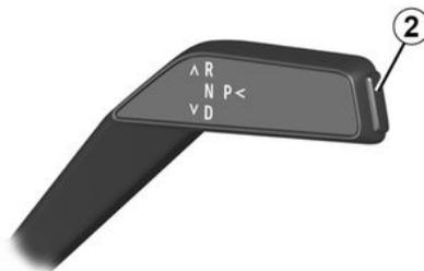
Com o veículo imobilizado e o motor ligado ou a ignição ligada, prima o botão **2** para engrenar a posição **P**.
