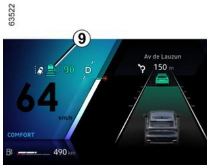
O radar é capaz de detetar o veículo que circula à sua frente. O sistema pode não funcionar corretamente se a zona de deteção do radar estiver tapada ou se o sinal for interrompido.
