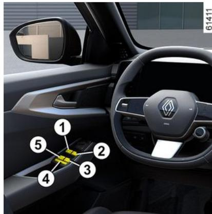
Pressione ou puxe brevemente um interruptor da janela até ao limite: a janela subirá ou descerá completamente. Uma ação no contactor interrompe o movimento do vidro.
