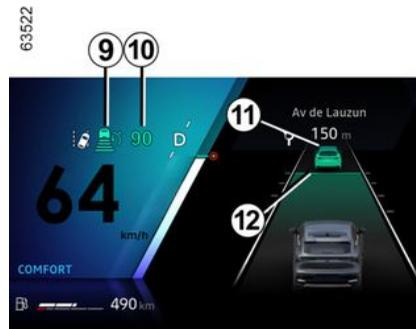
**9.** Testemunho do regulador de velocidade adaptativo Stop and Go.
