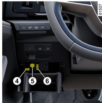
Desligue o fusível com a alavanca **4** situada no painel de fusíveis.
