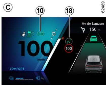
Utilizando a câmara, a função "Detecção de sinais de trânsito" → 242e o mapa adquirido com a subscrição, o sistema pode antecipar e gerir a adaptação automática da velocidade **10** quando o veículo se aproxima de uma rotunda ou de uma curva.
