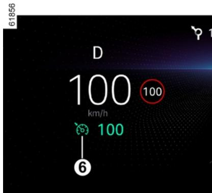
O testemunho 6 desaparece do quadro de instrumentos para confirmar que a função foi interrompida.
