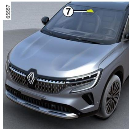
Consoante o veículo, os máximos adaptativos estão divididos em diversos segmentos verticais independentes. Esta função utiliza uma câmara **7** situada atrás do retrovisor interior para detetar os veículos à frente e os veículos que circulem em sentido inverso.
