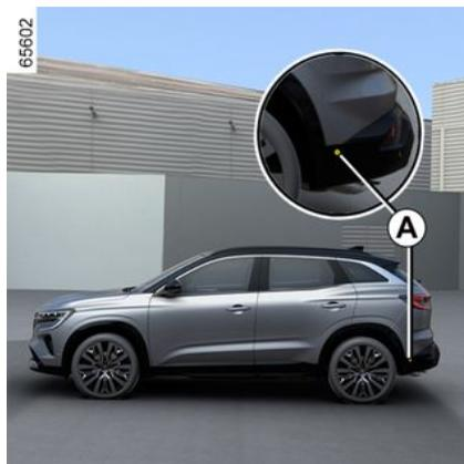
Utilizando a informação dos radares instalados em cada um dos lados do para-choques traseiro (área **A**), o sistema notifica o condutor quando aparecer outro veículo na zona de deteção **B**.
