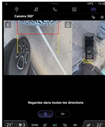
Se for detetado um obstáculo nas proximidades da dianteira ou da traseira do veículo, a função "Zoom auto" mudará a visualização atual para uma visualização específica (vista superior, frontal ou traseira).
