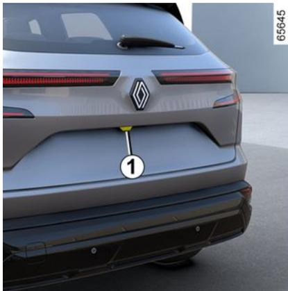
Quando o veículo está em marcha-atrás, a câmara **1** situada no porta-bagagens transmite a imagem da área circundante atrás do veículo ao visor multimédia **2**, em conjunto com uma a três guias **3**, **4** e **5** (guias fixa, móvel e do atrelado).
