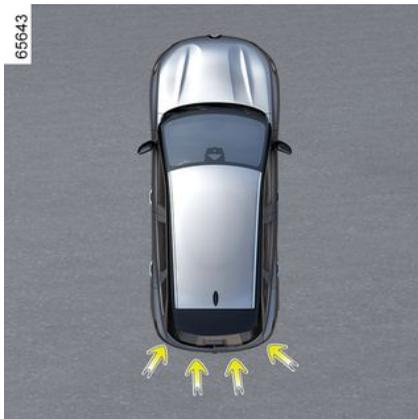
Além da função de "Ajuda ao estacionamento" → 289 e utilizando as informações dos quatro sensores centrais situados na traseira do veículo, o sistema deteta obstáculos fixos situados por trás do veículo. Se existir um risco de colisão significativo, o sistema trava o veículo automaticamente.
