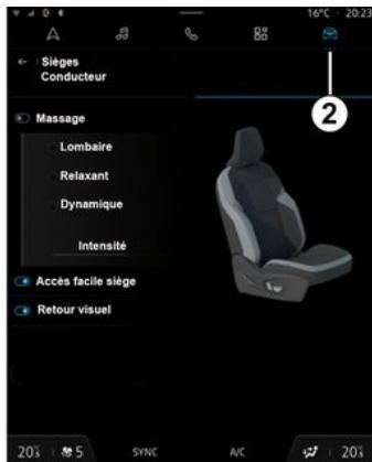
Com a ignição ligada, a partir do ecrã multimédia, seleccione o mundo do "Veículo" **2**, e depois "Bancos", seguido de "Massagem".
