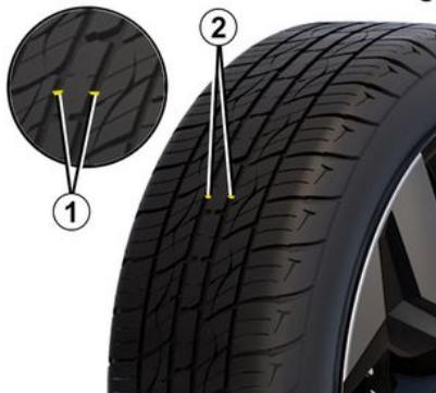
Quando o piso do pneu estiver gasto até ao nível dos indicadores de desgaste, **estes tornar-se-ão visíveis 2: em seguida, será necessário substituir os pneus, dado que a profundidade do piso será de apenas 1,6 mm, no máximo, provocando uma aderência deficiente em estradas molhadas.**
