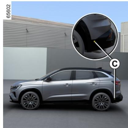
Certifique-se de que a zona **C** em torno dos radares de cada um dos lados do para-choques traseiro não está obstruída (por sujidade, lama, neve, etc.).
