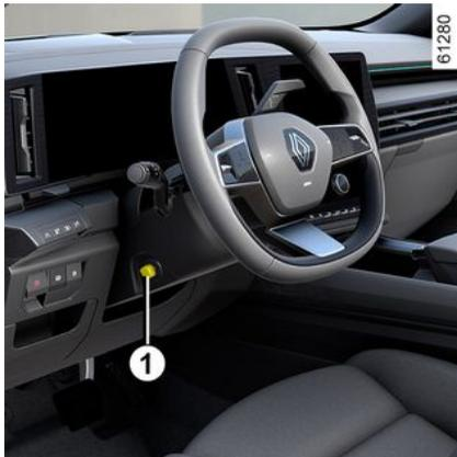
Baixe a alavanca **1** e configure o volante para a posição pretendida.
