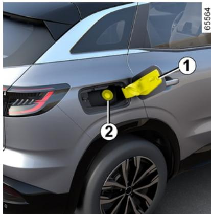
A válvula **2** está integrada no tubo de enchimento.
