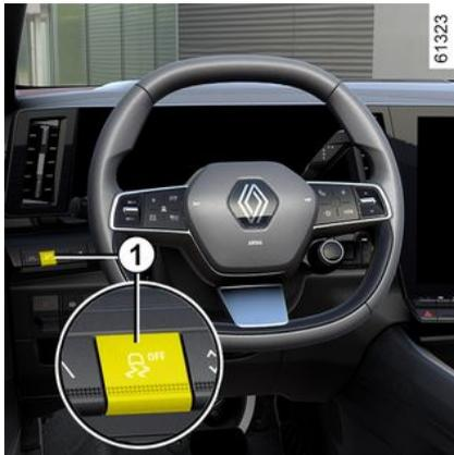
Em algumas situações (condução em piso muito mole como, por exemplo, neve ou lama, ou condução com pneus com correntes de neve), o sistema poderá reduzir a potência do motor para limitar a derrapagem das rodas. Ativar a função premindo o interruptor **1**. Quando este não for o efeito pretendido, a função pode ser desativada; para isso, prima o interruptor **1**. Neste
