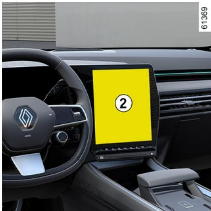
Quando a marcha-atrás for engrenada, no ecrã multimédia, prima o botão "Definições" para adicionar ou remover as guias e configurar as definições de imagem da câmara (luminosidade, contraste, etc.).
