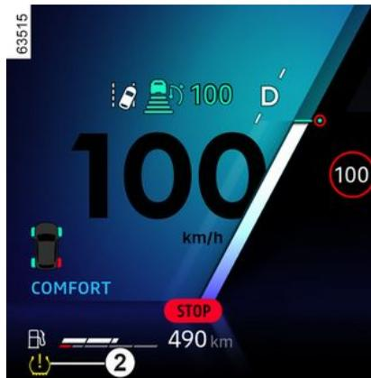
Este sistema detecta uma perda de pressão num dos pneus medindo a velocidade das rodas durante a condução.
