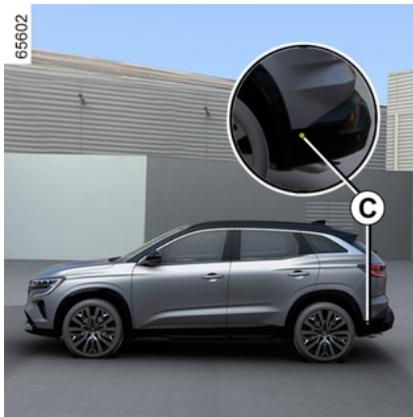
Utilizando as informações provenientes dos sensores montados em cada um dos lados do para-choques traseiro (zona **C**), a função avisa o condutor:
