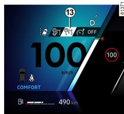
Prima o interruptor **3** para seleccionar o regulador de velocidade adaptativo **13**. O testemunho **9** é apresentado a cinzento. A mensagem "Regulador adaptativo pronto: SET para ativar" é apresentada no quadro de instrumentos, acompanhada de traços, de modo a indicar que a função do regulador de velocidade está em funcionamento e a aguardar a memorização de uma velocidade de regulação.
