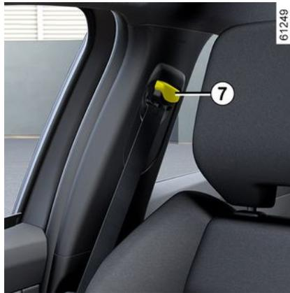
Prima o botão **7** para regular a altura do cinto de forma a que o segmento torácico fique conforme indicado anteriormente. Prima o botão **7** e suba ou desça o cinto. Depois de concluída a regulação, assegure-se do seu correto travamento.
