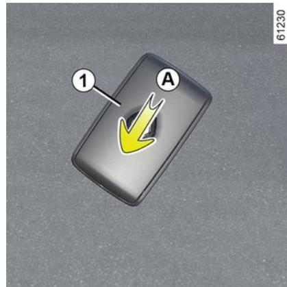
Quando a mensagem "Bateria do cartão baixa" aparecer no painel de instrumentos, substitua a pilha do cartão:
