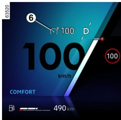
**i** Para sair da assistência à condução, pressione o interruptor **1** quantas vezes forem necessárias até estar DESLIGADO. A mensagem "Ajuda à condução desativada" é apresentada no quadro de instrumentos. Neste caso, na próxima vez que o motor for ligado, a função do "Limitador de velocidade" será ativada e aguardará a memorização de um limite de velocidade.
