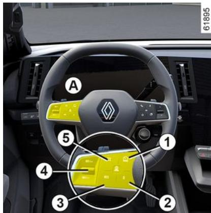
A função do limitador de velocidade será suspensa quando premir o interruptor **2** (0).
