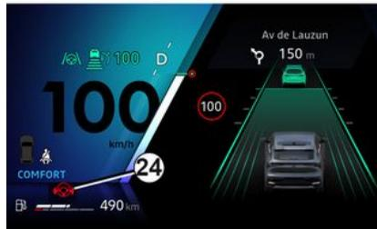
Quando a função "Sistema de assistência à condução no centro da via." deixar de detetar as mãos do condutor no volante, serão acionados diversos níveis de aviso:
