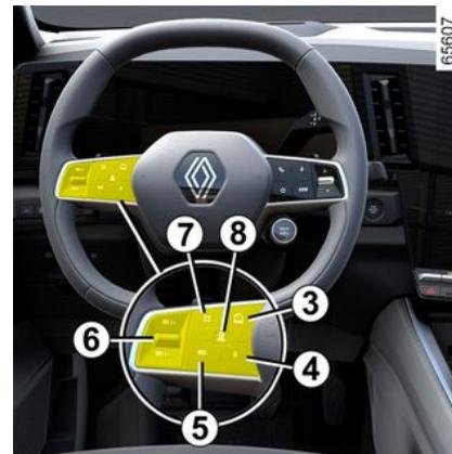
**3.** Interruptor para selecionar/desmarcar os assistentes de condução, dependendo do veículo:
