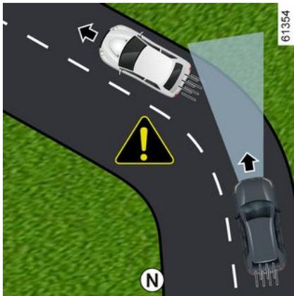
Ao entrar numa curva, o radar e/ou a câmara podem, momentaneamente, não detetar o veículo em frente (por exemplo, **N**).
