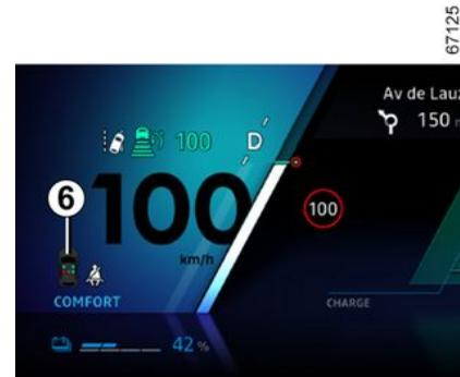
Com as portas fechadas, o gráfico **6** é apresentado no quadro de instrumentos durante aproximadamente 60 segundos quando a ignição do veículo é ligada. Isto informa sempre o condutor se o cinto de segurança de cada um dos lugares dianteiros está ou não encaixado:
