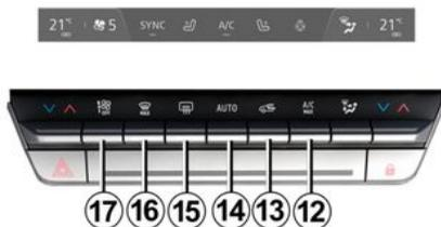
Prima o botão **15** e a luz de aviso integrada acende-se. Esta função permite um desembaçamento rápido ou o degelo do óculo traseiro e dos retrovisores (em veículos equipados).
