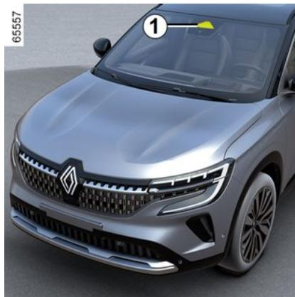
Utilizando informações da câmara 1, a função ativa uma ação corretiva ao nível do sistema da direção do veículo quando um traço contínuo ou tracejado é cruzado ou ao aproximar-se da berma da estrada (divisória, barreira, passeio, ravina, etc.) sem ativação dos indicadores de luz.
