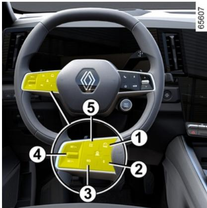
**1.** Interruptor para selecionar/desmarcar os assistentes de condução, dependendo do veículo:
