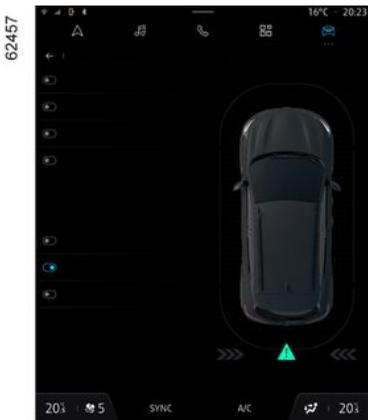
Para ativar ou desativar a função, seleccione o mundo "Veículo" e, em seguida, "Sistemas de ajuda ao estacionamento". Seleccione "Travagem de emergência ativa em marcha-atrás". Se a função for desativada, o testemu-
