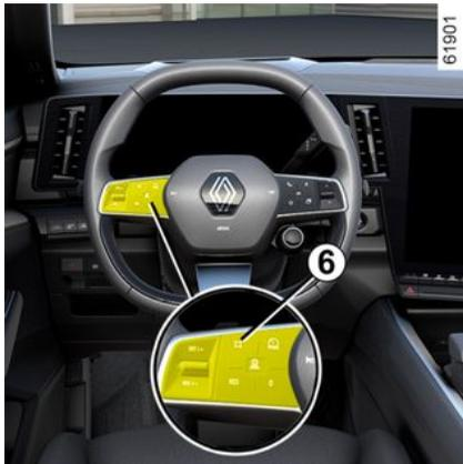
Para adaptar a referência do limitador de velocidade, do regulador de velocidade ou do regulador de velocidade adaptativo ao limite de velocidade detetado, prima o interruptor **6**.
