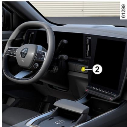
Nos veículos com caixa de velocidades automática, o veículo deve estar imobilizado e a alavanca na posição **P**. Em veículos E-Tech full hybrid, a mensagem **READY** é apresentada no quadro de instrumentos.
