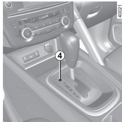
**Ao pôr o motor a trabalhar**, se a alavanca ficar bloqueada na posição **P** com o pé no pedal de travão, é possível desbloqueá-la manualmente. Para o fazer, coloque uma ferramenta (haste rígida) na ranhura **4** para soltar a alavanca.
