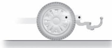
Nenhum equipamento de reboque deve obstruir qualquer componente de iluminação ou a placa de matrícula quando não estiver a ser utilizado. Os equipamentos de reboque mecânicos (bola, gancho, etc.) que possam ser removidos sem ferramentas ou sejam retráteis devem ser removidos ou reposicionados quando não estiverem a ser utilizados.
