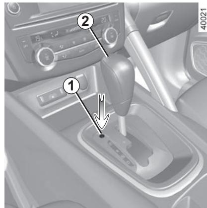
Se a alavanca ficar bloqueada em **P** com o pé no pedal de travão, é possível libertar manualmente a alavanca. Para o fazer, coloque uma ferramenta (haste rígida) na ranhura **1** e prima simultaneamente o botão **2** para soltar a alavanca.
