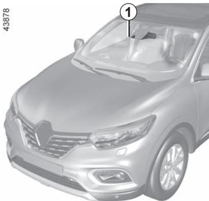
O alerta de excesso de velocidade com reconhecimento de painéis de sinalização, informa o condutor se este ultrapassar o limite de velocidade imposto para o troço de via no qual se encontra.
