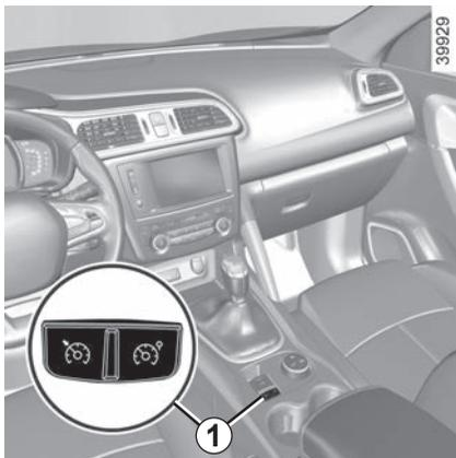
O regulador de velocidade permite-lhe conduzir a uma velocidade estabilizada, dita **velocidade de regulação**.
