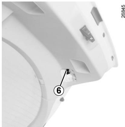
Desaperte o parafuso 6, para poder retirar o bloco de luzes 7, empurrando-o para o exterior.
