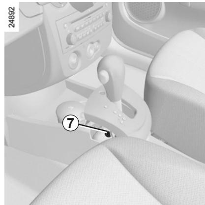
**Ao pôr o motor a trabalhar**, se a alavanca ficar bloqueada na posição **P**, com o pé no pedal de travão, é possível desbloqueá-la manualmente. Para isso, desencaixe a base da alavanca e prima simultaneamente a marca **7**, visível no fole, e o botão de destravamento situado na alavanca.
