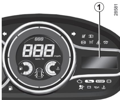
Nos veículos que a possuam, esta função, integrada no computador de bordo **1**, permite activar/desactivar e ajustar algumas funções do veículo.
