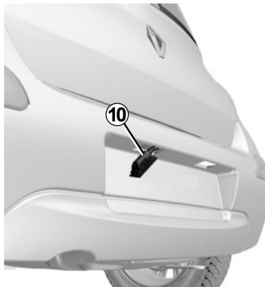
Desligue o conjunto e retire a tampa, para aceder à lâmpada **10**.
