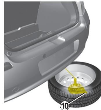
Coloque-se por trás do veículo e puxe pela pega **6** para levantar a roda, até que fique encaixada sob o veículo.
