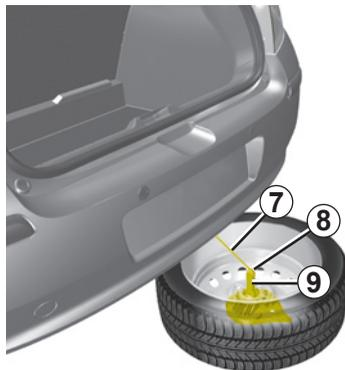
Depois de mudar uma roda, coloque a roda substituída no suporte **9**, com a válvula virada para o solo. Encaixe o cabo **7** no seu alojamento **8** e, em seguida, empurre a roda para debaixo do porta-bagagens.
