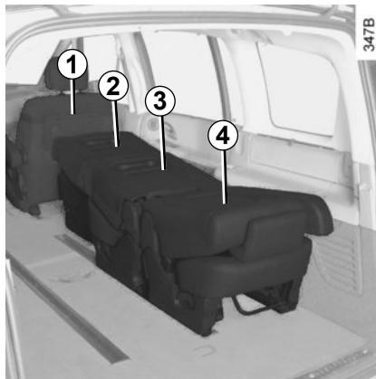
Em seguida, instale o banco **3** nas calhas **B**, com o encosto rebatido, e faça-o avançar totalmente. Depois, instale o banco **4**, na **posição de costas para a dianteira do veículo**, com o encosto rebatido, nas calhas **B** e posicione-o o mais atrás possível; em seguida, faça recuar os bancos **3**, depois **2** e, por fim, o banco dianteiro **1**.
