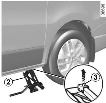
Coloque o macaco **2** horizontalmente. A cabeça do macaco **3** deve coincidir com o orifício previsto na parte inferior da carroçaria e o mais próximo possível da roda a substituir.
