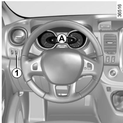
**Quadro de instrumentos A:** ilumina-se ao ligar a ignição. Pode regular a intensidade luminosa rodando o botão **1**. Em simultâneo com o acendimento de alguns testemunhos, é afixada uma mensagem.
