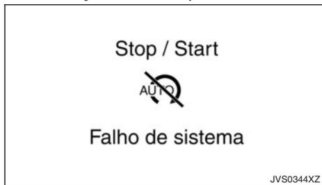
A mensagem é apresentada se o motor pára quando o Sistema de Paragem/Arranque é activado e não arranca automaticamente.
