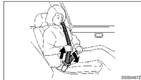
3. Coloque a secção inferior do cinto em posição baixa sobre a anca, de acordo com a figura.
