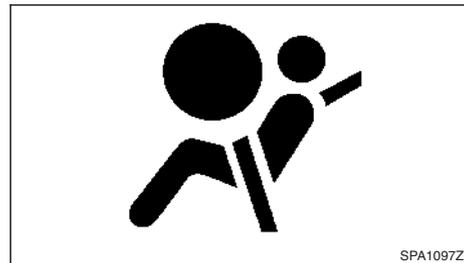
A luz de aviso do airbag suplementar, apresentada no painel de instrumentos, monitoriza os circuitos dos sistemas dos airbags, cintos de segurança com pré-tensor (consoante equipamento) e todas as cablagens relacionadas.
