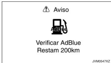
Este aviso fornece uma estimativa da distância (0 a 1000 km (0 a 621 milhas)) que poderá ser conduzida antes de inspeccionar e/ou reparar o sistema SCR de AdBlue®.
